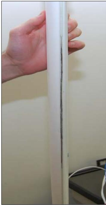
Figure 5 Edge Crack
