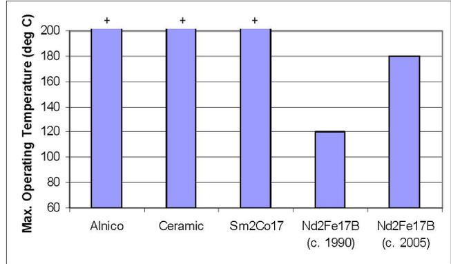
Fig. 1(d) Maximum Magnet Operating Temperature
