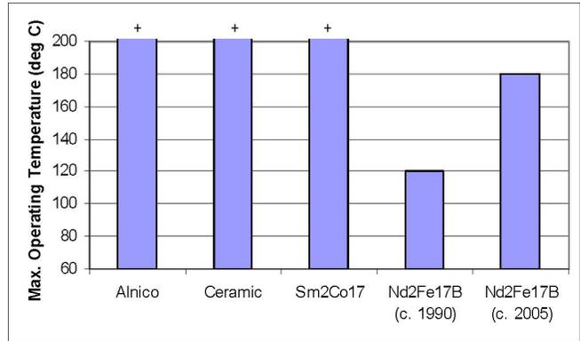
Fig. 1(d) Maximum Magnet Operating Temperature
