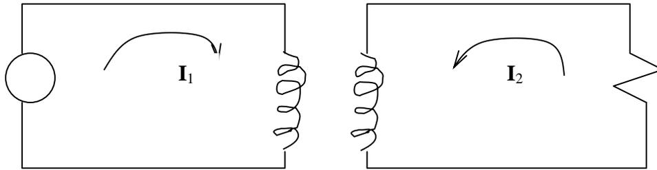
$$\text{Left loop: } 5 \cos(4t + 45^\circ) = 8i_1(t) + 4 \frac{di_1(t)}{dt} = 2 \frac{di_2(t)}{dt}$$
