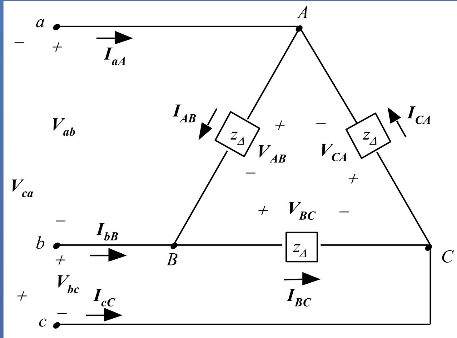
$$V_{AB} = V_{\phi}$$
