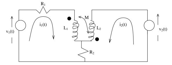
a. Left loop:  $v_1(t) = [i_1(t) + i_2(t)]R_2 + L_1 di_1(t)/dt - M di_2(t)/dt + R_1 i_1(t)$ b. Right loop :  $v_2(t) = [i_1(t) + i_2(t)]R_2 + L_2 di_2(t)/dt - M di_1(t)/dt$
